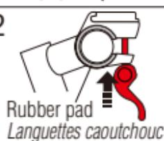
Fixez le collier sur le guidon. Placez les languettes caoutchouc à l'intérieur Du collier afin d'assurer un parfait maintien.
